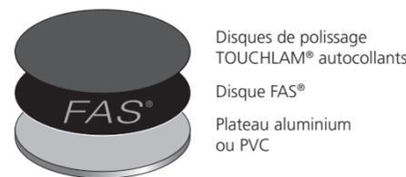
**FAS®-M :** magnétique, équipé d'un support adaptable sur plateau magnétique.
