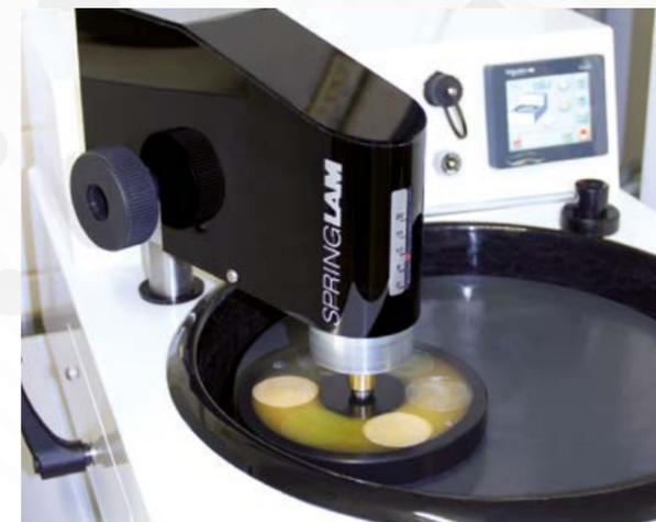
Optionen: SPRINGLAM<sup>®</sup>-Druck Arm, um Ihren SMARTLAM<sup>®</sup> als halbautomatische Poliermaschine zu verwenden
