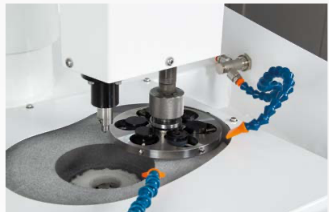
Teile auf einem Zentraldruck-Probenhalter zu schleifen
