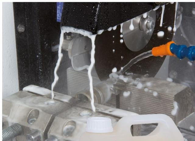
Pour contrôler la bonne concentration du fluide utilisez le RÉFRACTOMÈTRE Code 60 CT900 10
