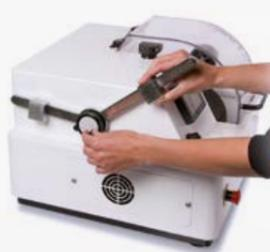
Manuelle mikrometrische Einstellung der Z-Achse.
