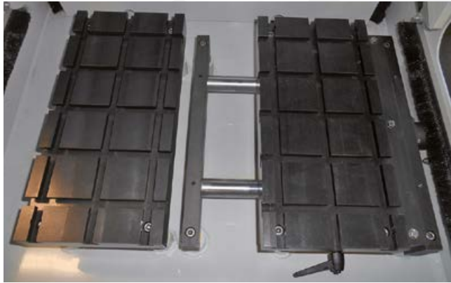
Tavola trasversale dell'asse X, corsa 120 mm
