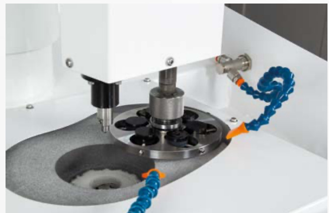
Teile auf einem Zentraldruck-Probenhalter zu schleifen
