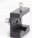
V-förmiger Probenhalter mit Schraubklemmung. Max. Kapazität: Ø 24 mm. 60 CTM03 20
