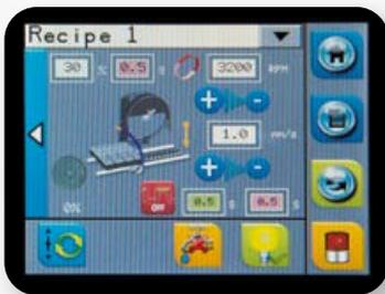
Der interne Speicher speichert 300 Programme mit Ausgangsposition, Vorschubgeschwindigkeit, Drehgeschwindigkeit und Schnittmodus.
