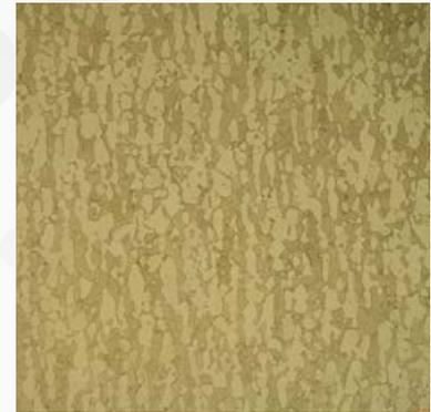
TA6V-Titan, das mit Krolls Reagenz geätzt wird
