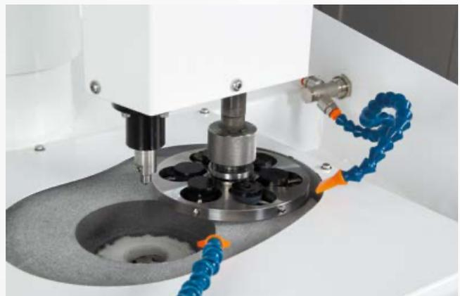
Abrichten und Schleifen sind wesentliche Schritte bei der Präparation einer metallografischen Probe. Es ist die Qualität dieser Schritte, die den Rest des Prozesses bestimmen und optimieren wird.
