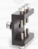
Probenhalter Multi-Schrauben-Spanner, für unregelmäßige Teile. 6 Spannschrauben. Höhe max. : 25 mm. 60 CTM03 50
