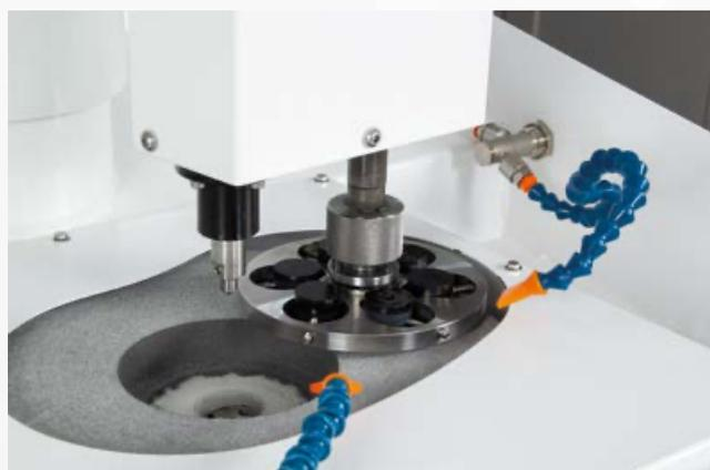
La rettifica e la preluclatura sono fasi essenziali nella preparazione di un campione metallografico. È la qualità di queste fasi che condiziona e ottimizza il resto del processo. Al termine della fase di rettifica, l'aspetto del campione deve essere uniforme e omogeneo, senza variazioni di planarità o di materiale.
