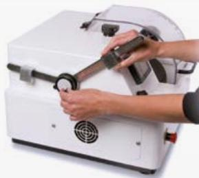
Regolazione micrometrica manuale dell'asse Z.
