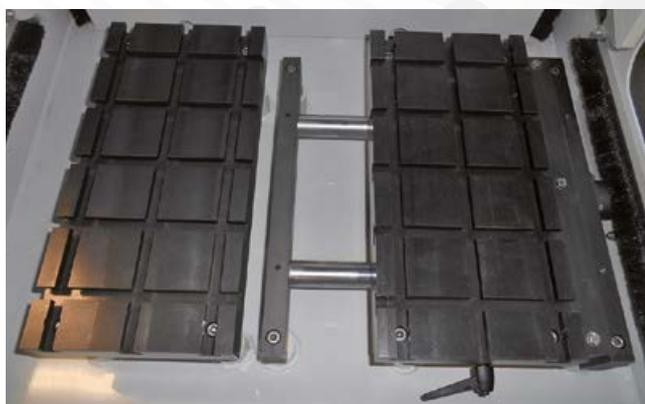
Tavola trasversale dell'asse X, corsa 120 mm
