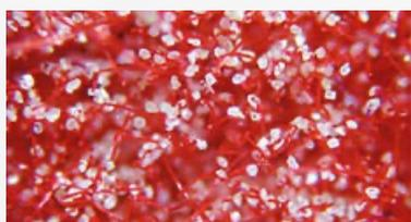
Fibre viscosa corte floccate
