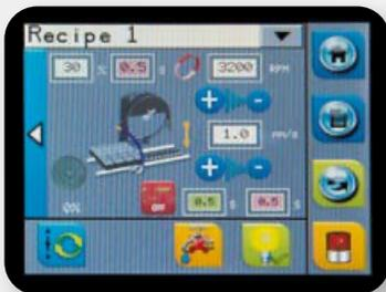
Der interne Speicher speichert 300 Programme mit Ausgangsposition, Vorschubgeschwindigkeit, Drehgeschwindigkeit und Schnittmodus.
