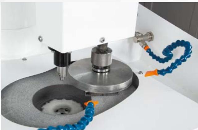
*Teile auf einem Zentraldruck-Probenhalter zu schleifen*
