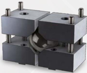
**Anwendungsbeispiele mit CUTLAM® 1.1: Schnitt mit Doppelscheibe von Glasbohrkernen**
