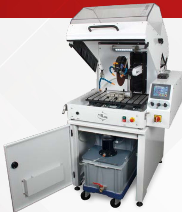
Meuble support avec système de recirculation (60 litres).
