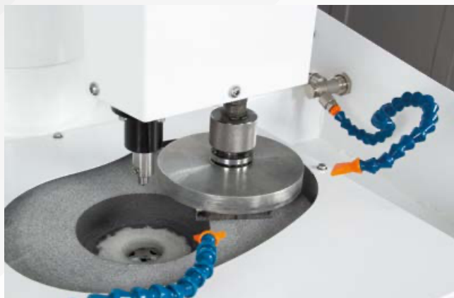
Prépolissage d'échantillons brutes de grande taille.
