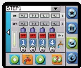
Programmation du doseur DISTRILAM intégrée aux commandes de la machine sur toute la gamme MASTERLAM®.
