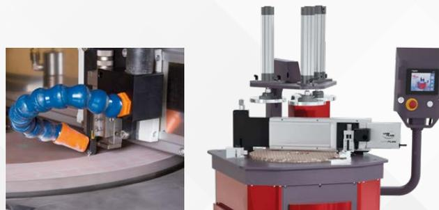
Il sistema AUTOPLAN consente di gestire efficacemente la planarità e la scanalatura del piano del disco e può essere montato e smontato in pochi minuti grazie ai punti di fissaggio dedicati integrati nella macchina.
