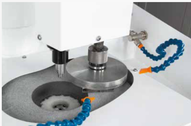
Prépolissage d'échantillons brutes de grande taille.
