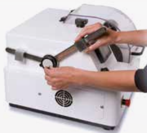
Manuelle mikrometrische Einstellung der Z-Achse.
