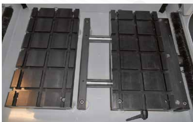
X-Achse Kreuztisch, Hub 120 mm
