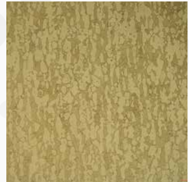
TA6V-Titan, das mit Krolls Reagenz geätzt wird
