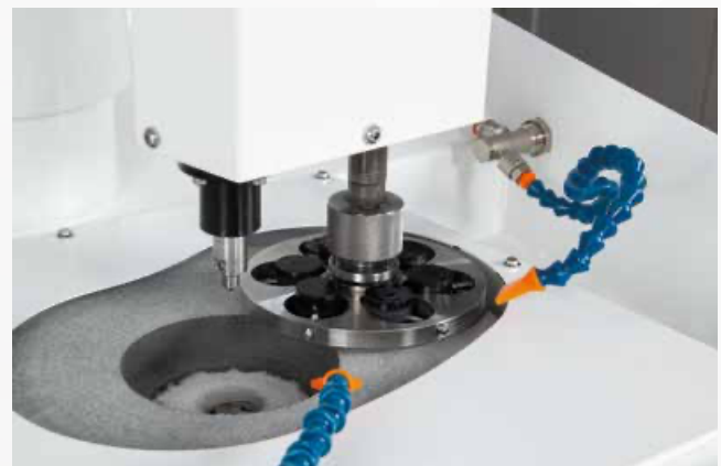
Teile auf einem Zentraldruck-Probenhalter zu schleifen
