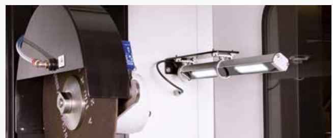
Gute Ausleuchtung des Schnittbereichs durch LED.
