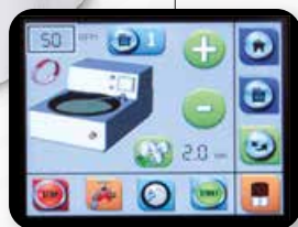
Interfaccia di controllo intuitiva schermo tattile a colori da 3,5"
