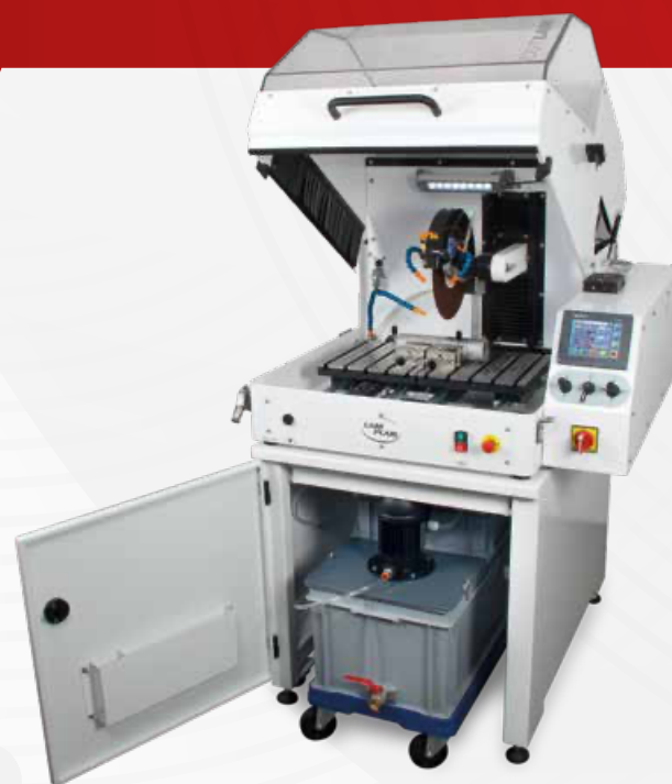
Mobile di supporto con sistema di ricircolo (60 litri).
