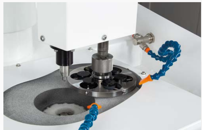
Teile auf einem Zentraldruck-Probenhalter zu schleifen
