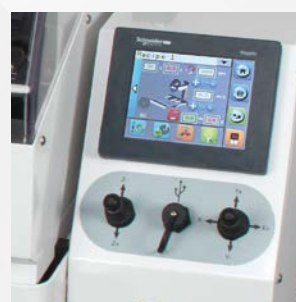
Schnellpositionierung mit Joysticks. Touchscreen mit graphischer Schnittstelle.
