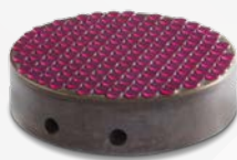
Polieren von Uhrenindustrieteile auf Plaketten montiert.
