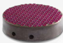
Polissage de pièces horlogères, montées sur tasseau
