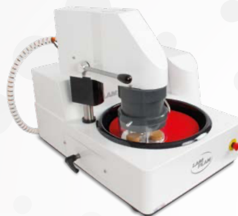
Tête motorisée à pression individuelle. Capacité : 3 échantillons du Ø 25,4 à 50 mm.
