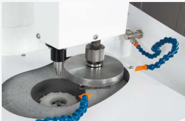
Prépolissage d'échantillons brutes de grande taille.
