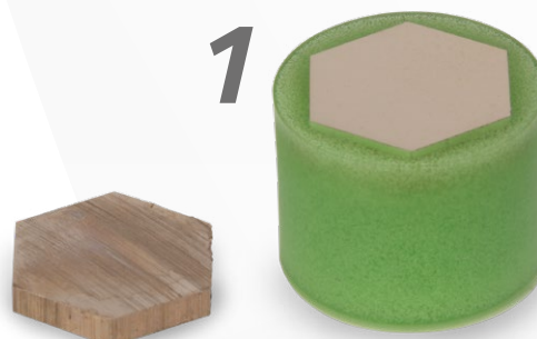
Échantillon enrobé après polissage
