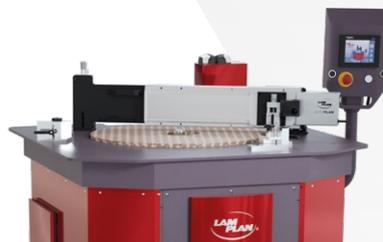
Le système AUTOPLAN permet de gérer efficacement la planéité et le rainurage du plateau, il se positionne et se démonte en quelques minutes grâce aux points de fixation dédiés intégrés à la machine.
