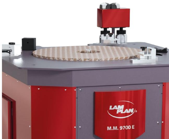
**Système AUTOPLAN : mise au plan et rainurage du plateau, voir détail page 29.**
