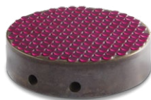
Polissage de pièces horlogères, montées sur tasseau
